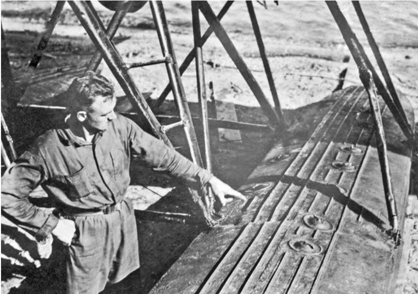
(252) Schwimmerbruch bei der F 13 Birkhahn
